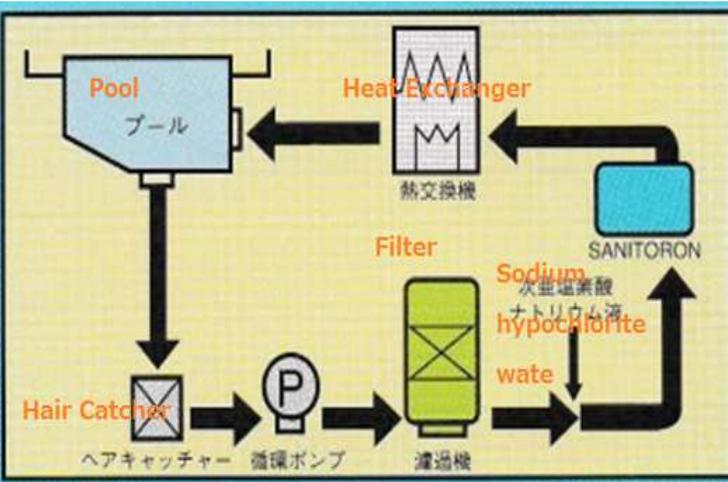
UZON+RAC (a) 主循環水処理法 (b) オーバーフロー水処理法
